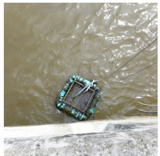
Wasserentnahmestelle einer Messstation. Das Wasser wird mit Hilfe einer Tauchpumpe, die durch einen groben Unterwasser-Metallkäfig gegen Treibgut und schnelle Verstopfung geschützt ist, entnommen. Ein Schwimmer ermöglicht die Wasserentnahme bei stark schwankenden Wasserständen.
